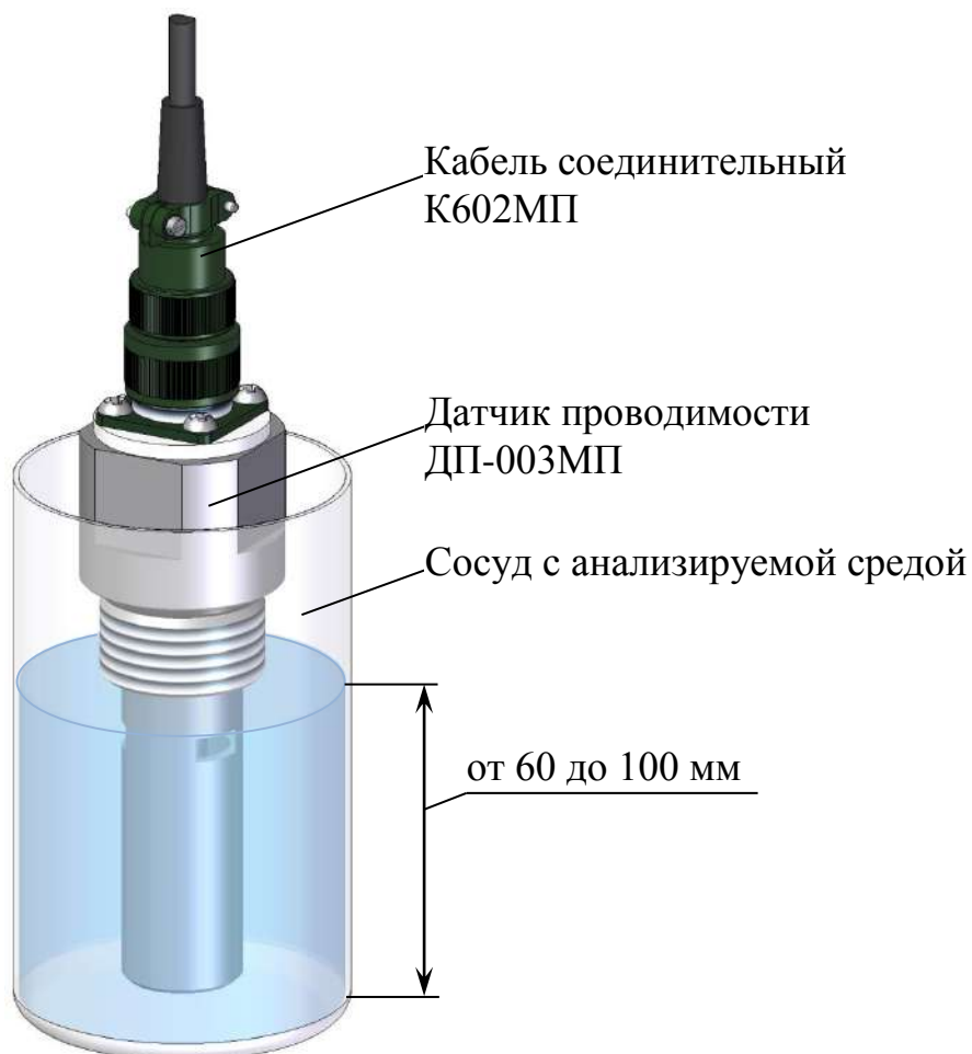
Рисунок 2.8 – Расположение датчика проводимости ДП-003МП в сосуде
